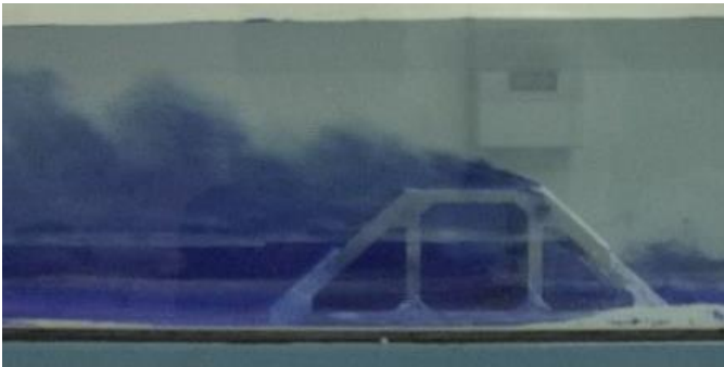
構造物背後で攪拌している様子
